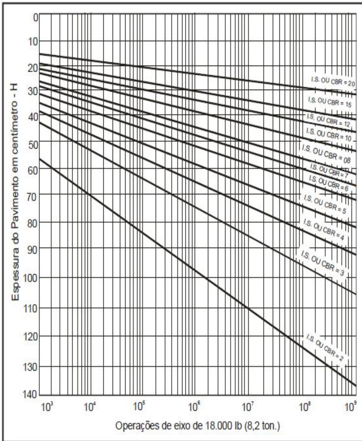
Figura5 –Curvas para determinação das espessuras das camadas
