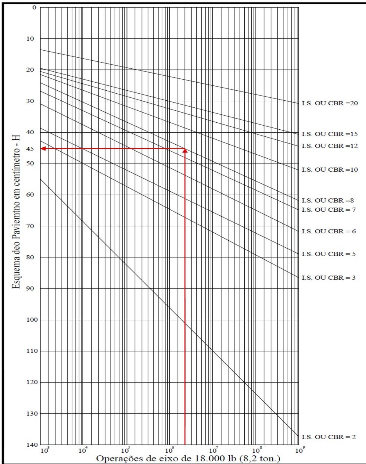
Figura 7 – Determinação do  $H_n = 45$  cm
